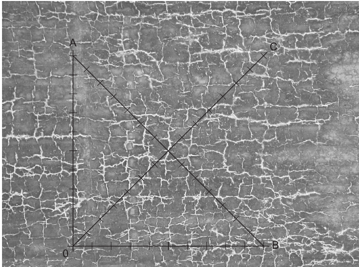
Figure 4: Disposition des quatre segments de mesure pour la détermination de l'indice d'ouverture des fissures RI
